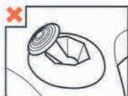
この時に、3Dスティックが傾いている場合(左上の図)、傾いた状態が「ニュートラルポジション」と設定されます。このようにニュートラルポジションの位置がズレた状態では、3Dスティックが正常に操作できなくなります。
