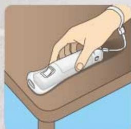
Wiiモーションプラスを取り付けたWiiリモコンが正しく反応しない場合は、ゲーム中にWiiリモコンの(A)側を下向きにして水平な場所(テーブルの上など)に数秒間置いてください。
