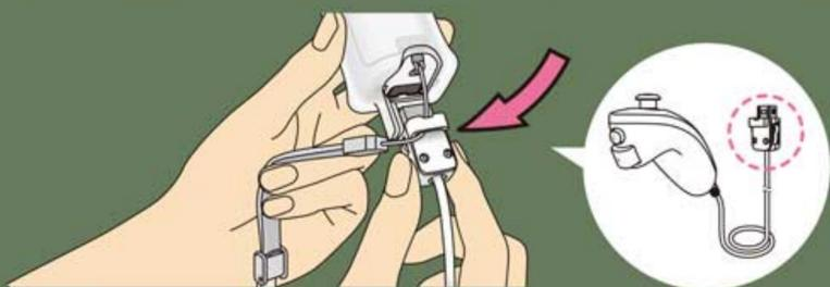
2. ひもを通した状態で、Wiiリモコンの外部拡張コネクタにヌンチャクのプラグを接続してください。
